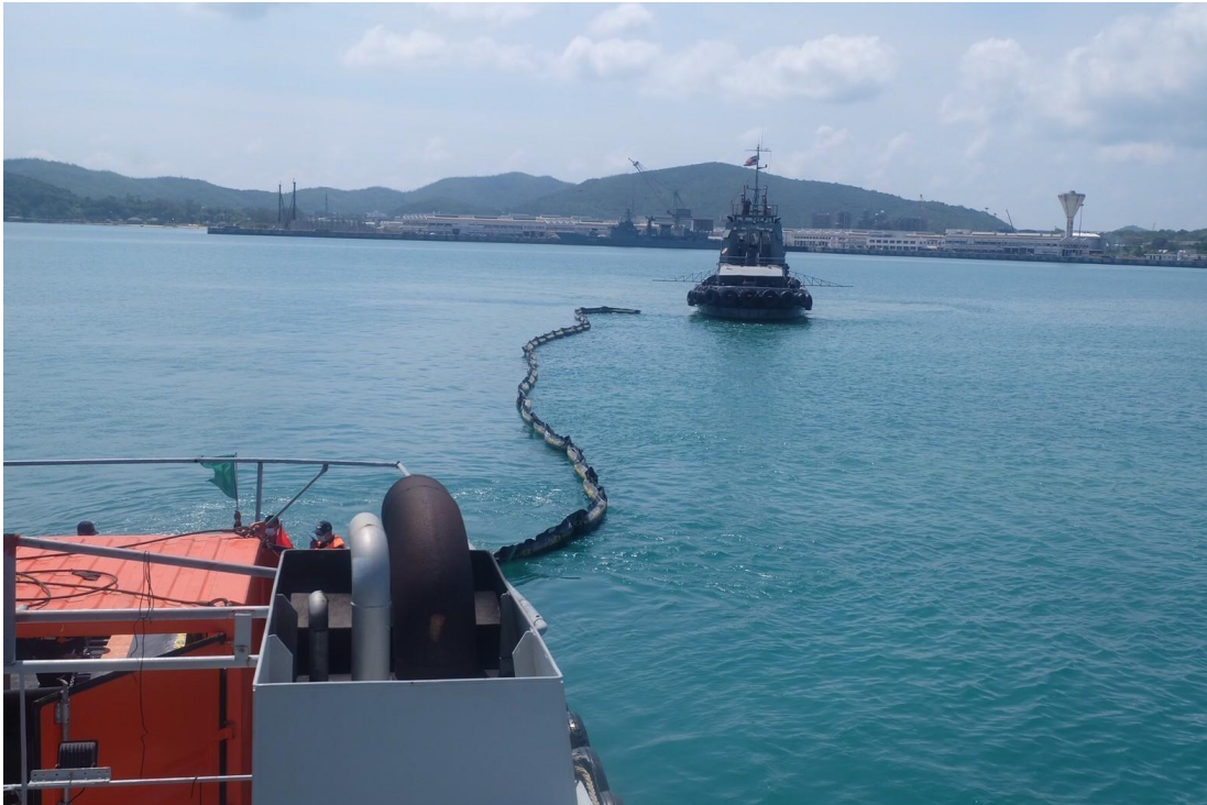
รูปภาพที่ ๕ เรือ รฐท.สส.๒๓ ลากทุ่นออกไปช้าๆ ลากทุ่นออกไปในแนวตรงและใช้ความเร็วต่ำ
