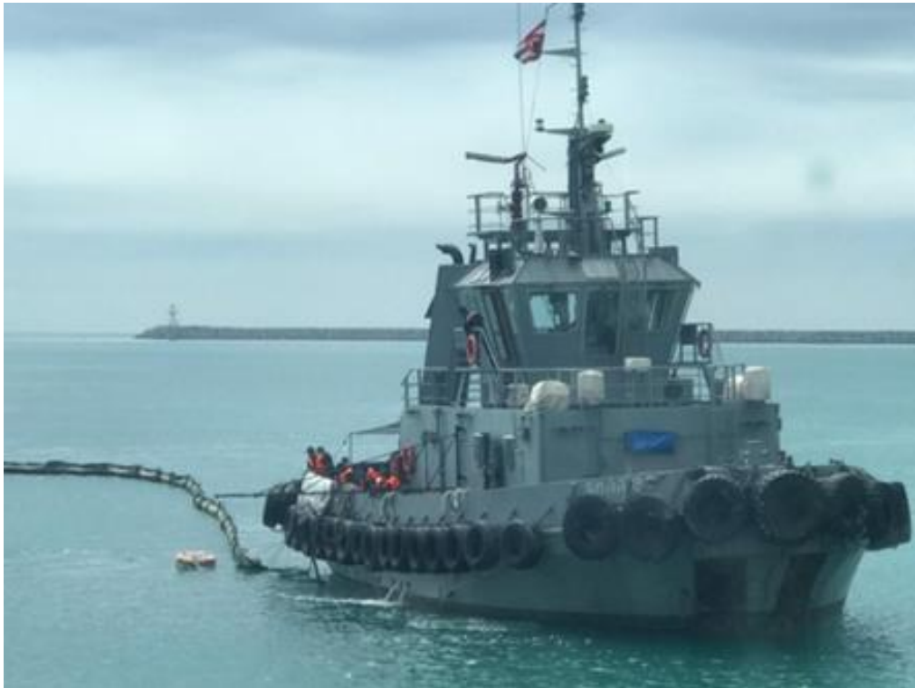
รูปภาพที่ ๗ เรือ รฐท.สส.๒๓ นำเครื่องดูดคราบน้ำมันลงน้ำ
