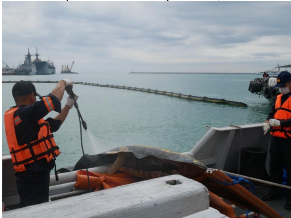
รูปภาพที่ ๑๐ การทำความสะอาดท่อนักคราบน้ำมันก่อนจัดเก็บเข้าร่น
